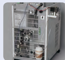
循環水の純度管理が可能。(写真はバイパス回路併設)
